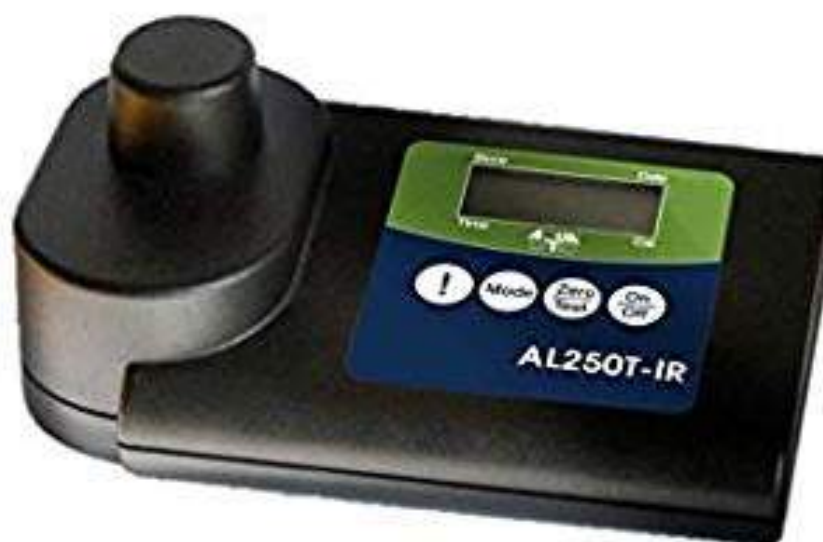
Figure 87 : Turbidimètre AL250T-IR de marque AQALYTIC utilisé par CMB
