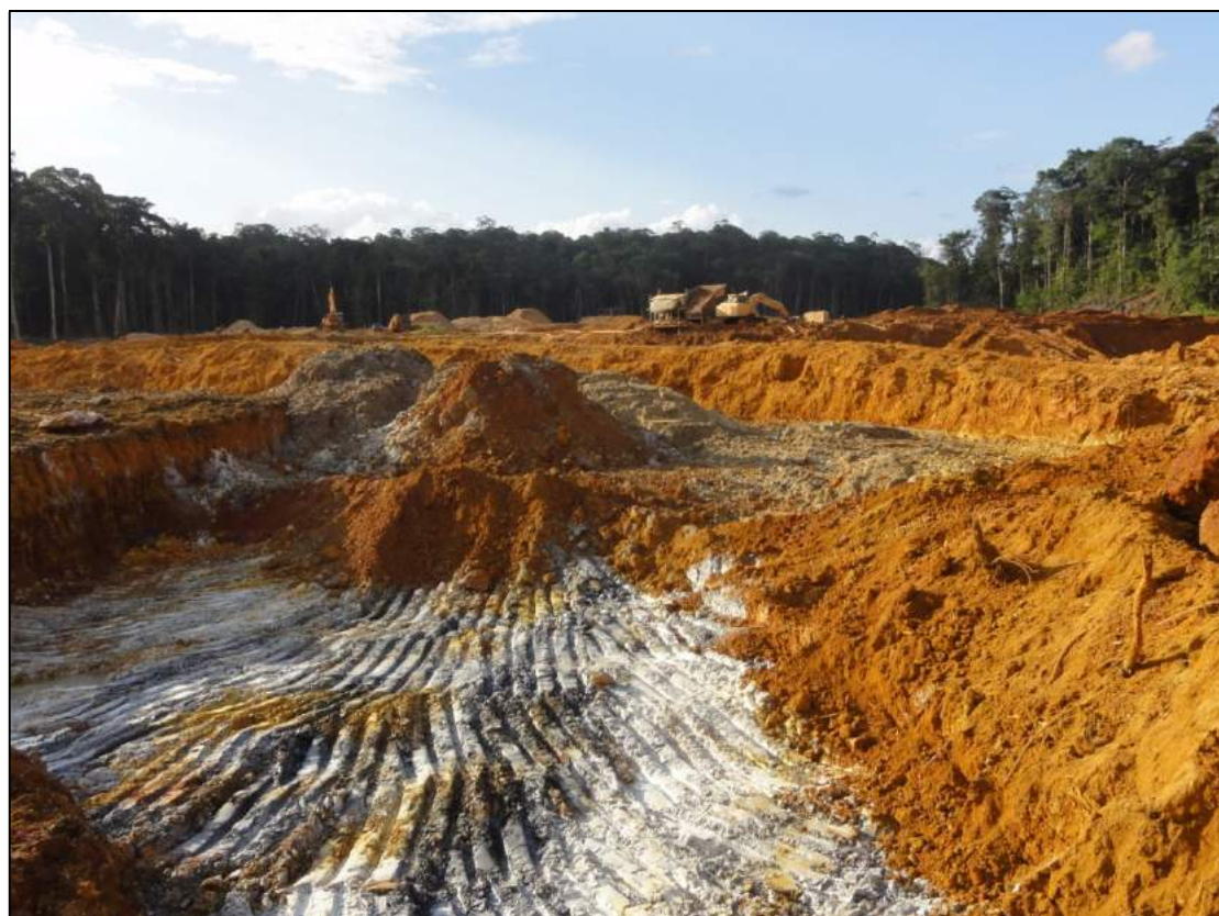
Figure 21 : Extraction et mise en tas du gravier minéralisé
