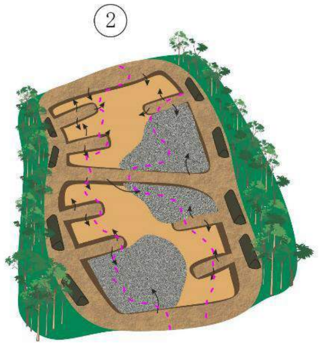
2) Régilage à la pelle mécanique des stériles de découverte argileux stockés au niveau des digues des bassins d'exploitation
