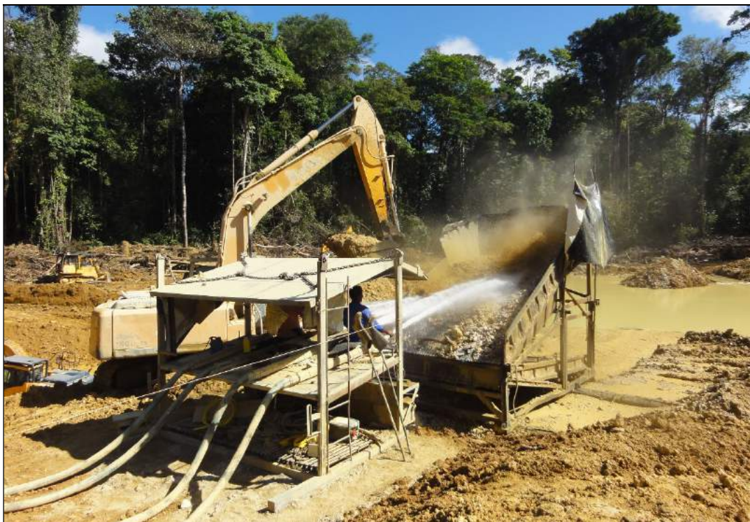
Figure 22 : Débourage du gravier minéralisé et piégeage de l'or dans les couloirs du sluice
